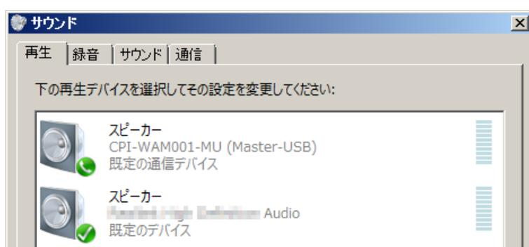
2. 「スピーカー CPI-WAM001-MU (Master-USB)」の項目を右クリックすると、以下のような画面になるので、「既定のデバイスとして設定(D)」を選んでクリックします。
