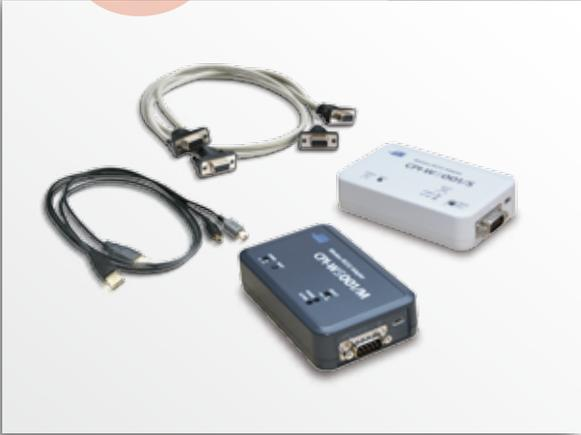
CPI-WS001 は、RS232 もしくはUSB (仮想COM ポート) の有線シリアル通信を無線通信に置き換えるユニットです。無線通信には2.4GHz 帯の無線モジュール (電波法認証品) を使用し、IEEE802.15.4 規格に対応しています。ユニットはマスターモジュールと、スレーブモジュール各1台の組み合わせで使用します。スレーブモジュールについては、RS232 レベルのシリアル通信ラインを無線に置き換えて使用する場合、接続するターゲット機器のDTR およびRTS からの給電を受けることが可能で、通信条件によっては、外部からの電源供給が不要となります。※1
