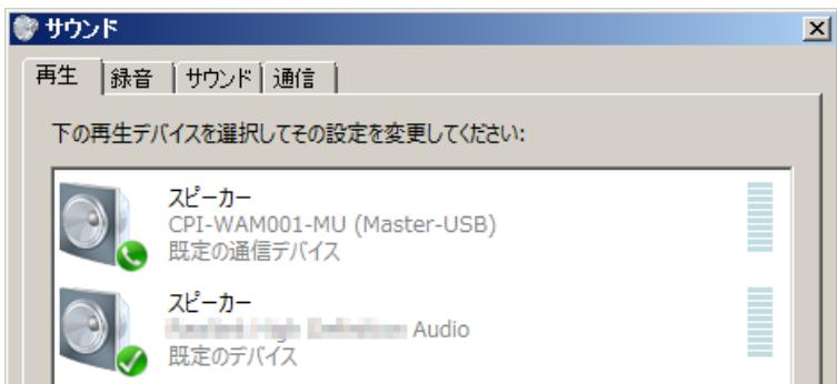
2. 「スピーカー CPI-WAM001-MU (Master-USB)」の項目を右クリックすると、以下のような画面になるので、「既定のデバイスとして設定(D)」を選んで、左クリックします。
