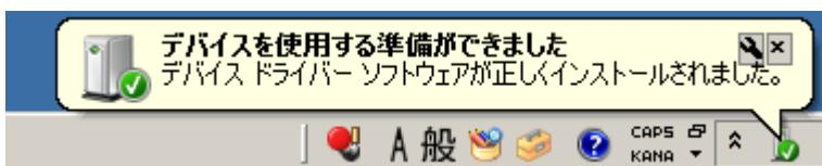
3. MU モジュールが正常に登録された場合は、デバイスマネージャー ([スタート]-[コントロールパネル]-[システムとセキュリティ]と開き、[システム]の下にある[デバイスマネージャー]をクリック) を見ると、以下のように "CPI-WAM001-MU (Master-USB)" が表示がされています。
