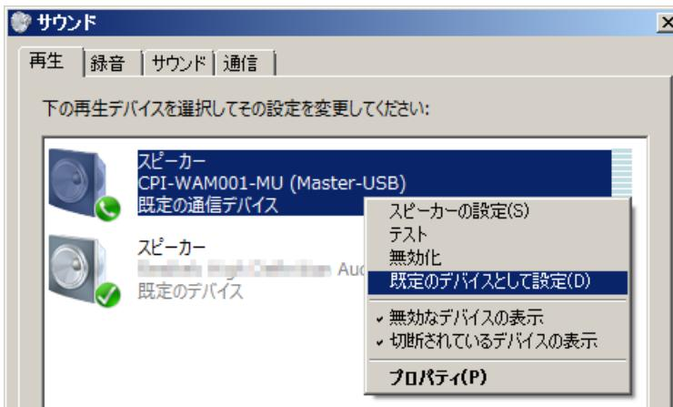
3. 「スピーカー CPI-WAM001-MU (Muster-USB)」の項目が、「既定のデバイス」になっていることを確認します。「OK」を左クリックして、この画面を閉じます。
