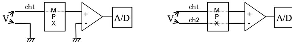
シングルエンド入力では対接地ノイズは変換結果に影響を与えるが、差動入力にすると対接地ノイズはch1とch2の間で相殺され変換結果に影響を与えない。ただし、差動入力方式では実質のチャンネル数はシングルエンドの半分になる。
