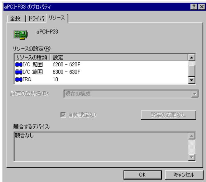
もし、競合するデバイスがある場合は、ご使用になられるPCに挿入されている他のデバイスのIRQ、I/Oポートなどのリソースを変更または削除してください。
