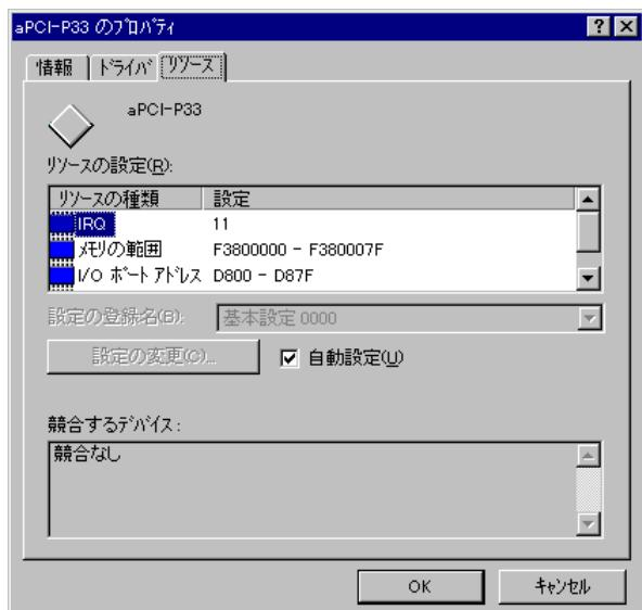
もし、競合するデバイスがある場合は、ご使用になられるPCに挿入されている他のデバイスのIRQ、I/Oポートなどのリソースを変更または削除してください。
