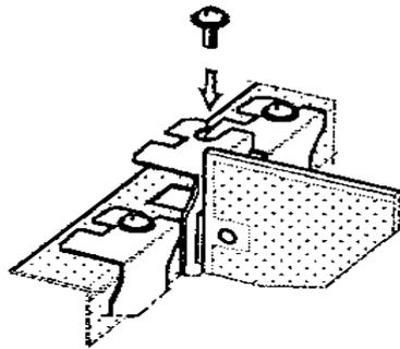
以上で PC への取り付けは終了です。取り外したスロットのブラケットはなくさないように保管してください。
