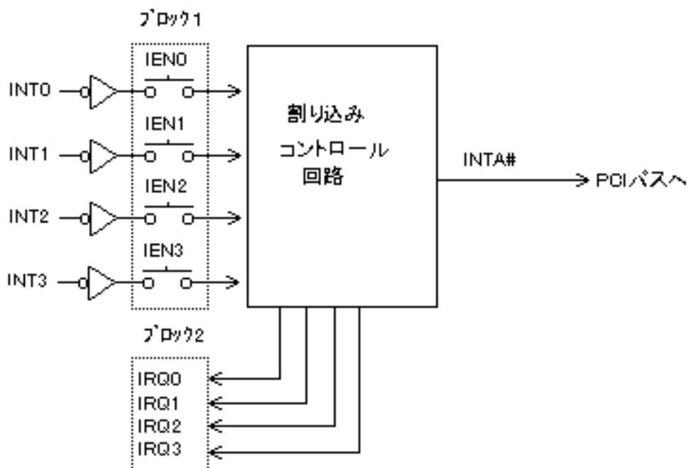
■ブロック 1 : External Interrupt Control Register (offset=Eh~Fh) Input, Output
