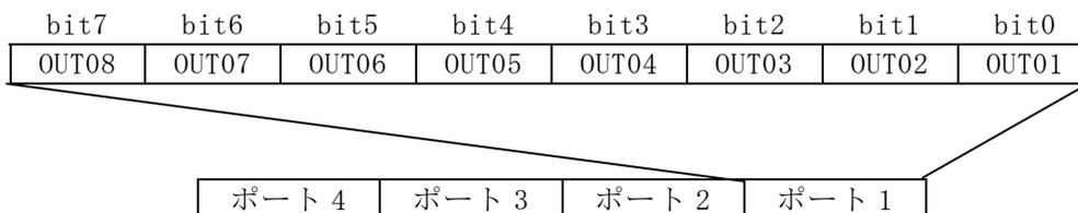
このように、本ボードの入力ポートは、1ポート当たり 8ビットで構成されており、合計 4ポート (32ビット) で使用できます。
