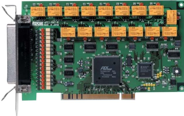
本ボードは、PCIバス拡張スロットを持っているPC-98NXシリーズおよび、PC/AT(DOS/V機)またはその互換機に絶縁の入出力機能を付加する拡張ボードです。
