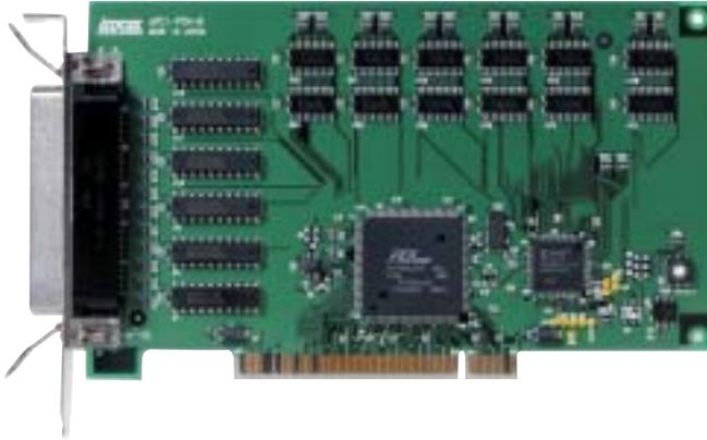
本ボードは、PCIバス拡張スロットを持っているPC98-NXシリーズおよび、PC/AT(DOS/V機)または、その互換機にTTLレベルの入出力を付加する拡張ボードです。
