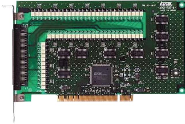
本ボードは、PCIバス拡張スロットを持っているPC98-NXシリーズおよび、PC/AT(DOS/V機)またはその互換機に絶縁デジタル出力を付加する拡張ボードです。
