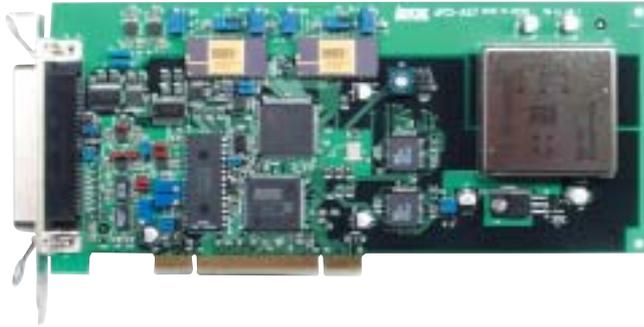
本ボードは、PCIバス拡張スロットを持っているパーソナルコンピュータにアナログ入出力機能およびTTLレベル入出力機能を付加する拡張ボードです。小規模なアナログ入出力とパラレル入出力利用する計測・制御を構築する際には最適な製品です。
