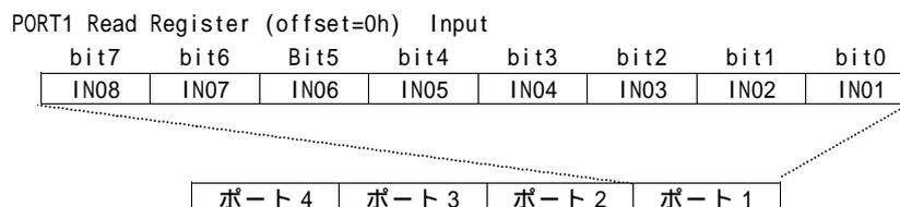
このように、本ボードの入力ポートは、1ポート当たり 8 ビットで構成されており、合計 8 ポート(64 ビット)で使用できます。
